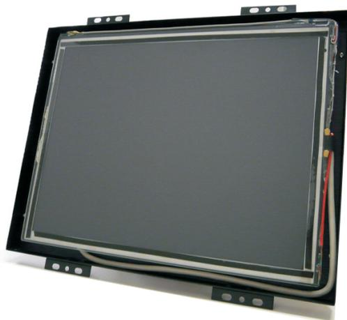
Monitor touchscreen profissional para uso industrial com tecnologia SAW para máxima resistência e confiabilidade operacional. Robustez e qualidade de imagens com operação da tela que dispensa o uso de "stylus pen". Gabinete metálico e fixação das placas com resistência a vibração / trepidação com fácil instalação em qualquer equipamento.
